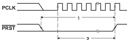
Figure 48. PCI Reset ( $\overline{\text{PRST}}$ ) Timing
