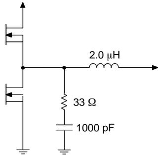
**Figure 20. Filter Components**
