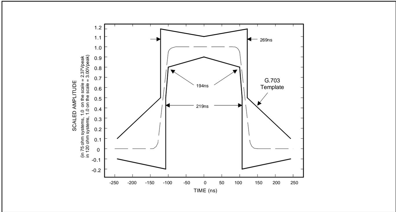
**Figure 25-8. T1 Transmit Pulse Template**
